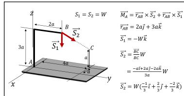
$$\begin{aligned} \overrightarrow{M_A} &= \left( 2a\vec{j} + 3a\vec{k} \right) \times \left( \frac{-1}{3}\vec{i} + \frac{2}{3}\vec{j} + \frac{-2}{3}\vec{k} \right) W + \left( 2a\vec{j} + 3a\vec{k} \right) \times \left( -W\vec{k} \right) \\ &= \left( \frac{2}{3}\vec{k} + \frac{-4}{3}\vec{i} - 1\vec{j} - 2\vec{i} - 2\vec{i} \right) Wa \end{aligned}$$
